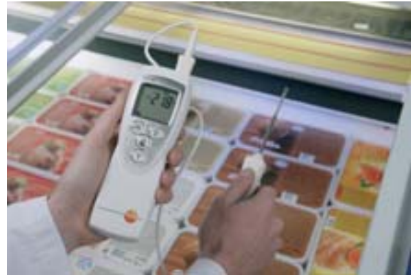
Mesure de température ambiante dans les vitrines réfrigérées et congélateurs
