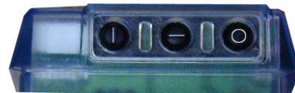
DETAIL CLAVIER (Vue de dessous)
