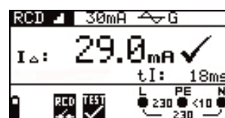
Test des disjoncteurs différentiels de 10mA à 650mA
