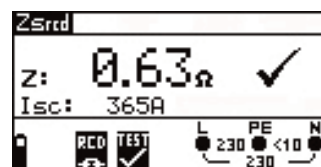
Mesure de boucle de terre
